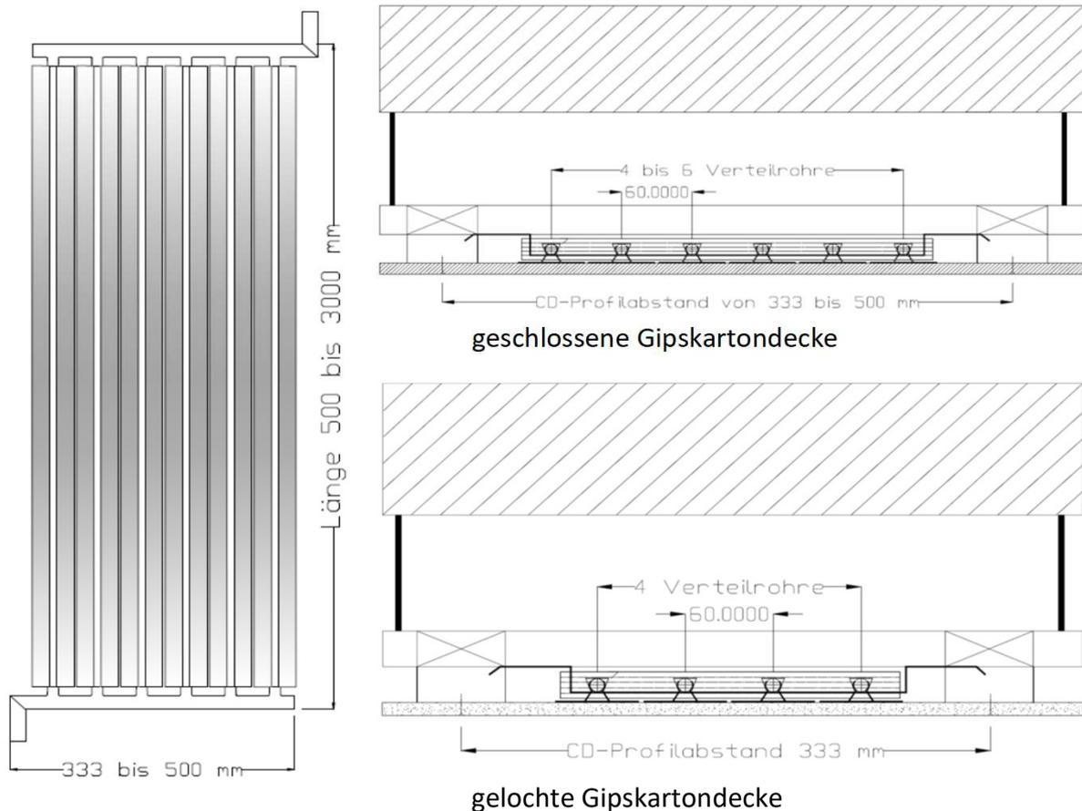
Die Wärmeleitbleche aus Aluminium liegen jeweils vollflächig auf der Gipskartonplatte auf und sorgen so für eine optimale Wärme- bzw. Kälteübertragung.
